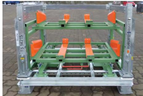
Seit Jahrzehnten ist es bei uns Standard, unsere Verbundbleche als Niederhalter oder Rausspring-sicherung in Transportbehältern einzusetzen.
